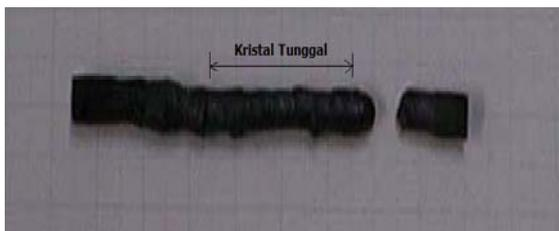
**Gambar 6.** Foto kristal tunggal yang telah dibuat dengan metoda FZ (diameter sekitar 5 mm )
